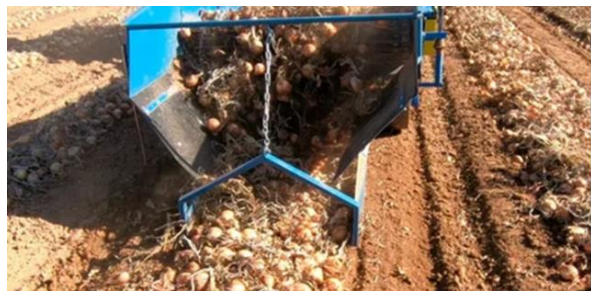
Рис. 3 – Викопування цибулі копачем-валкокладачем КЛ-1,4А
