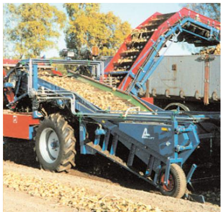
Рис. 7 – Цибулезбиральний комбайн Asa Lift
