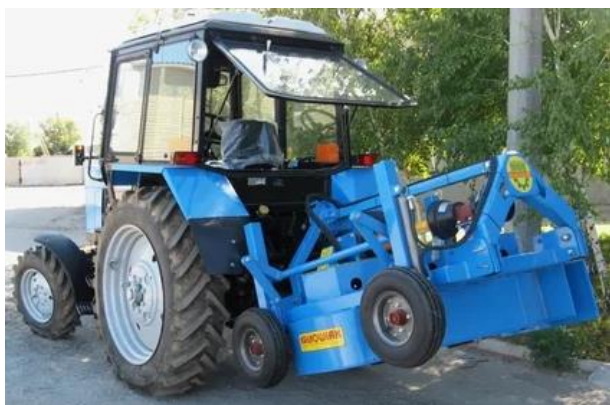
Рис. 1 – Машина для зрізування бадилля Krukowiak
