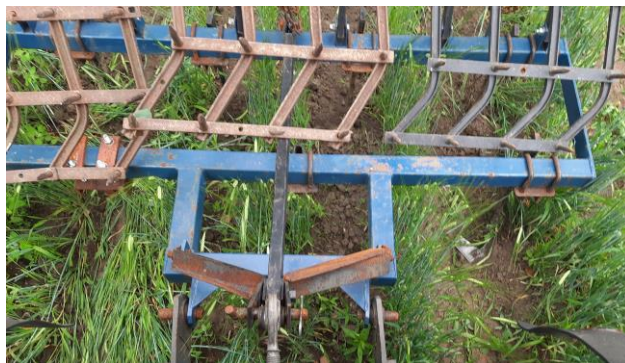
Рис. 3 – Фото міжрядного обробітку смугового посіву ячменю культиватором КУ-1,6
