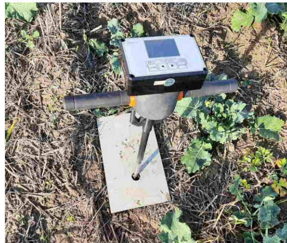
Рис. 7 – Завершення процесу вимірювання внаслідок досягнення максимальної глибини введення твердоміра
