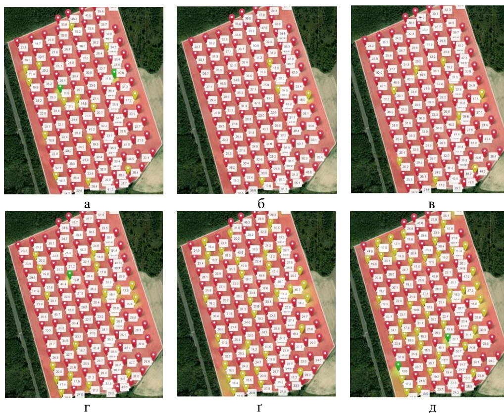
Рис. 16 – Картограма розподілу твердості ґрунту поля 7 за глибинами: а – 25 см; б – 30 см; в – 35 см; г – 40 см; г – 45 см; д – 50 см
