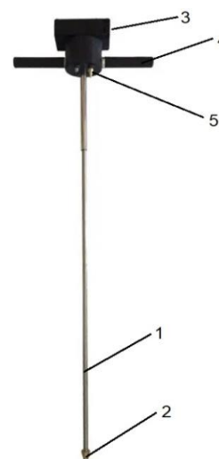
Рис. 3 – Твердомір ґрунту «Лан-М PRO»: 1 – металевий щуп; 2 – наконечник малий ( d = 12,7 мм); 3 – електронний блок; 4 – основа з рукоятками; 5 – наконечник великий ( d = 19,1 мм)
