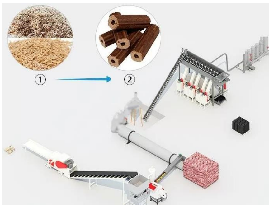
Рис. 5 – Лінія виробництва брикетів типу Pini&Kaу (Shuliy Machinery, n.d.): 1 – сировина; 2 – брикети
