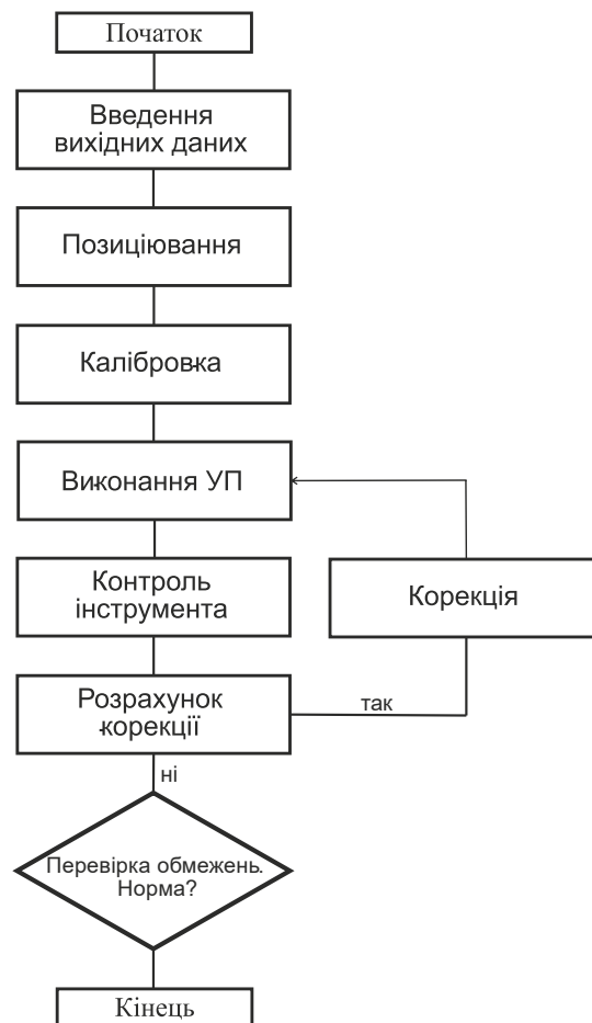
Рисунок 5 – Блок-схема алгоритма підналаштування інструмента
