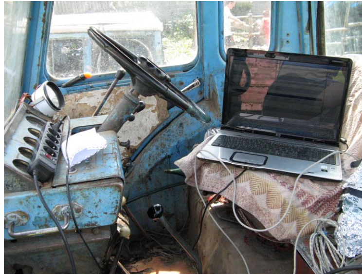
Рисунок 3 – Реєструюча апаратура (ноутбук і АЦП) в кабіні трактора МТЗ-80
