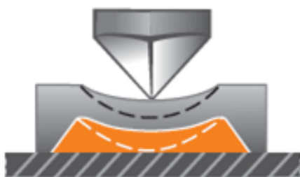
Рис. 15. Схема вимірювання властивостей мембрани і експериментальна крива навантаження-розвантаження: жорсткість і прогин мембрани (а), мембрана впирається в підкладку (б)
