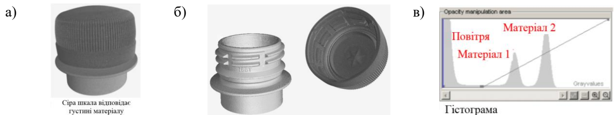
Рисунок 4 – Результат сканування складання (а) з наступним поділом на компоненти (б) та аналізом особливостей їх матеріалу (в)
