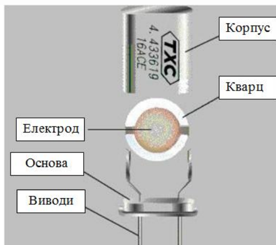
Рисунок 1 – Будова кварцового резонатора
