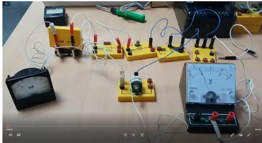
Рис. 2. Фото експериментальної установки для визначення аварійного стану скритої електричної мережі.
