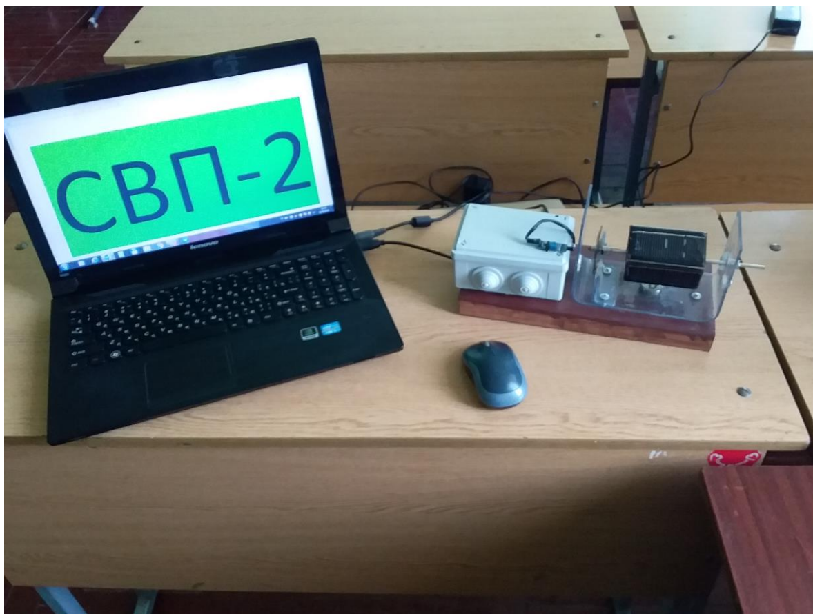
Рис.2. Пристрій СВП-2 для реєстрації, відтворення інформації та обробки результатів виміру освітленості.
