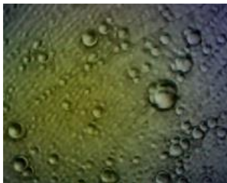
Рис. 1. Морфологія поверхні «трьохвалентних» хромових покриттів, х400 – оксалатно-сульфатний електроліт хромування
