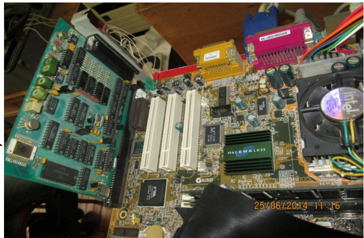
Рис. 4. Загальний вигляд материнської плати комп'ютера з вмонтованою платою АЦП L-154
