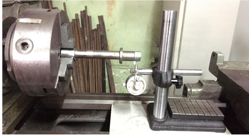
Рис. 5. Вивчення згинної жорсткості попередньо стиснутих труб.
