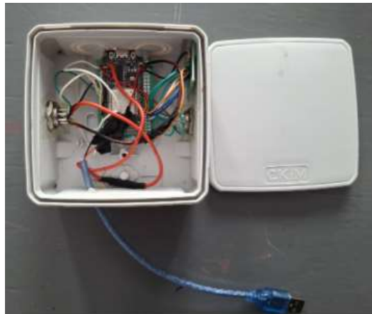
Рисунок 2 – Внутрішній вигляд корпусу з ESP32 та платою дільників напруги
