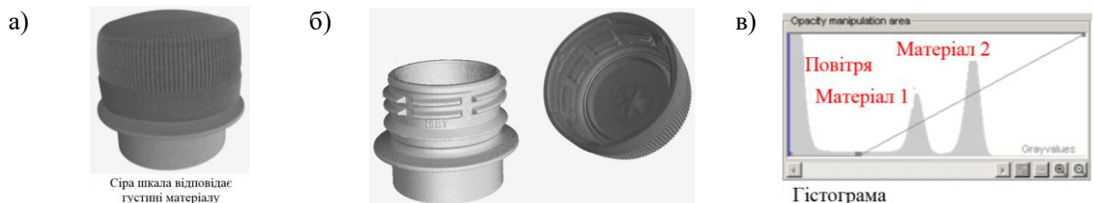
Рисунок 4 – Результат сканування складання (а) з наступним поділом на компоненти (б) та аналізом особливостей їх матеріалу (в)
