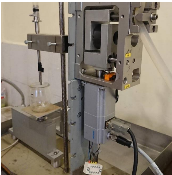
Рисунок 3 – Загальний вигляд дозуючого пристрою експериментальної установки для дослідження технологічного процесу дозування інфузійних розчинів
