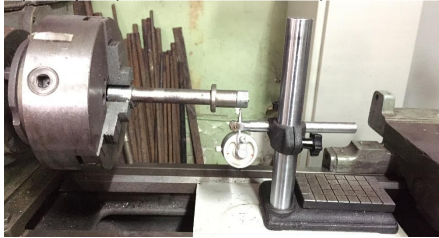
Рис. 5. Вивчення згинної жорсткості попередньо стиснутих труб.
