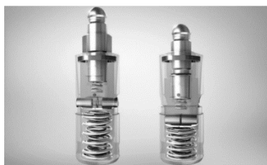
а) при активованому циліндрі; б) циліндр деактивовано
