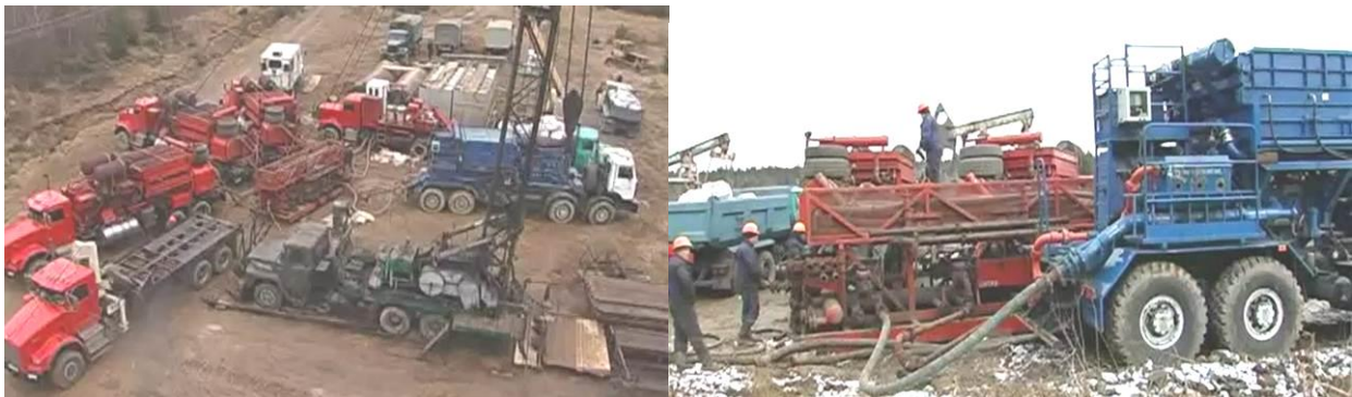
Рисунок 1. Проведення промислових випробовувань на базі мобільного агрегату для гідравлічного розриву пластів мод. Halliburton Tier IV DGB на шасі Мерседес 4150 (8x8)
