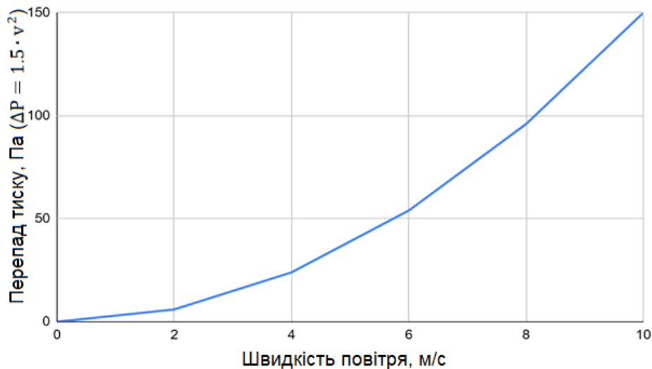
Рисунок 1 – Залежність перепаду тиску ( \Delta P ) від швидкості повітря ( v ) для повітряного фільтра
