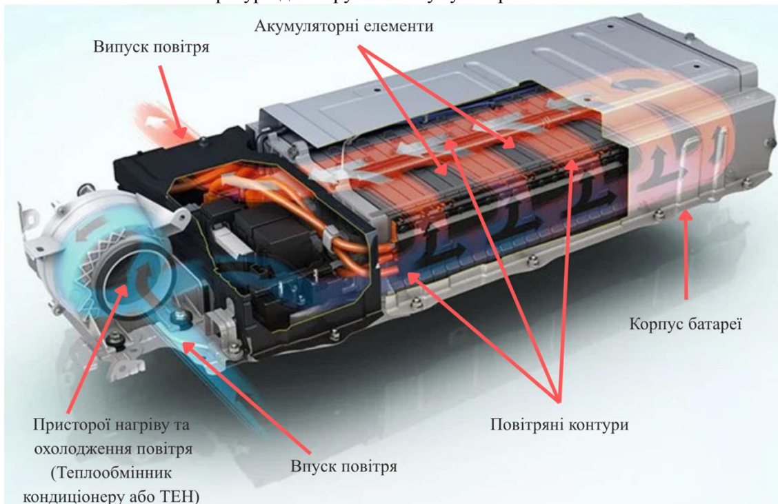
Рисунок 2 – Структура батареї з повітряною системою терморегуляції батареї
