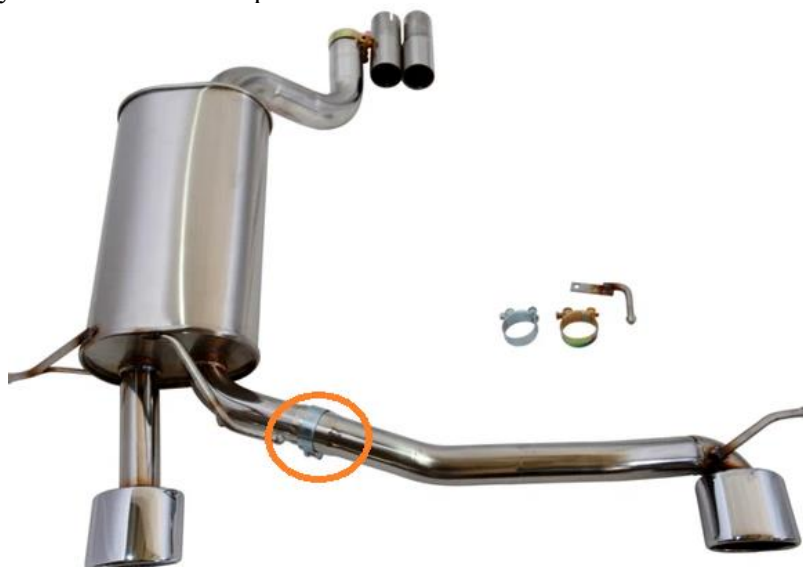
Рисунок 1. Місце перехідного діаметру на з'єднувальному патрубку вихлопної системи автомобіля Mercedes W203 та S203.
