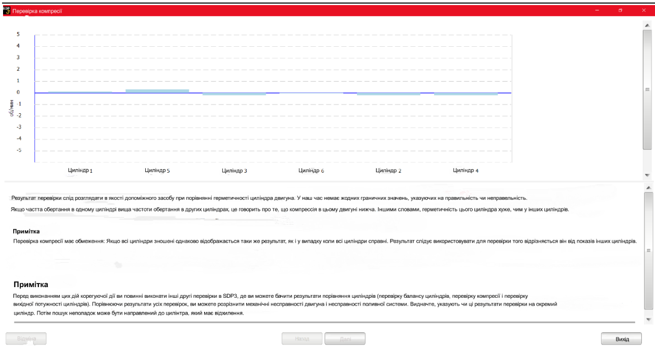
Рисунок 7 – Результат виконання функції «Перевірка компресії»
