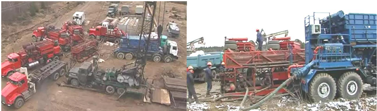
Рисунок 1. Проведення промислових випробувань на базі мобільного агрегату для гідравлічного розриву пластів мод. Halliburton Tier IV DGB на шасі Мерседес 4150 (8x8)
