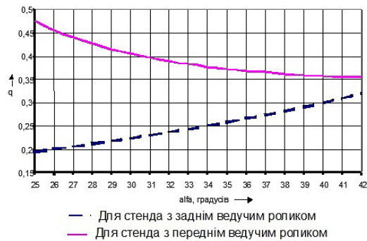
Рисунок 2 – Залежності коефіцієнта q використання навантаження від кута \alpha для різних схем розташування роликів стенда симетричної схеми
