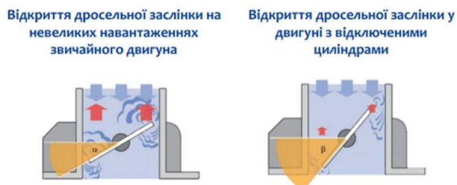
Рисунок 1. Положення дросельної заслінки [7]
