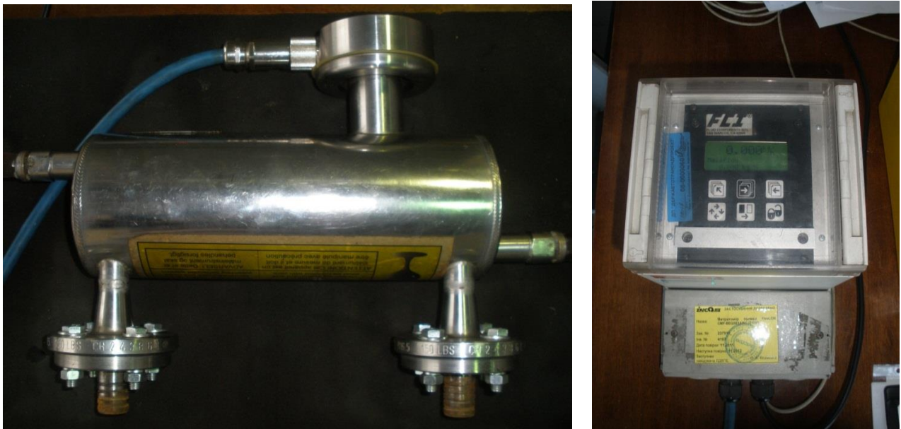
Рисунок 3 – Масовий витратомір палива коріолісового типу FlexCOR
