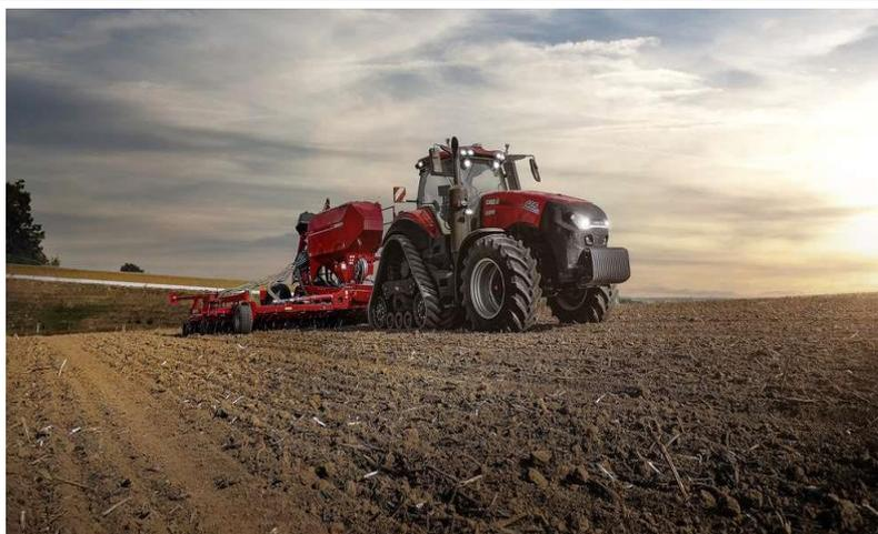
Рисунок 7 – Трактор на півгусеничному ході системи Rowtrac
