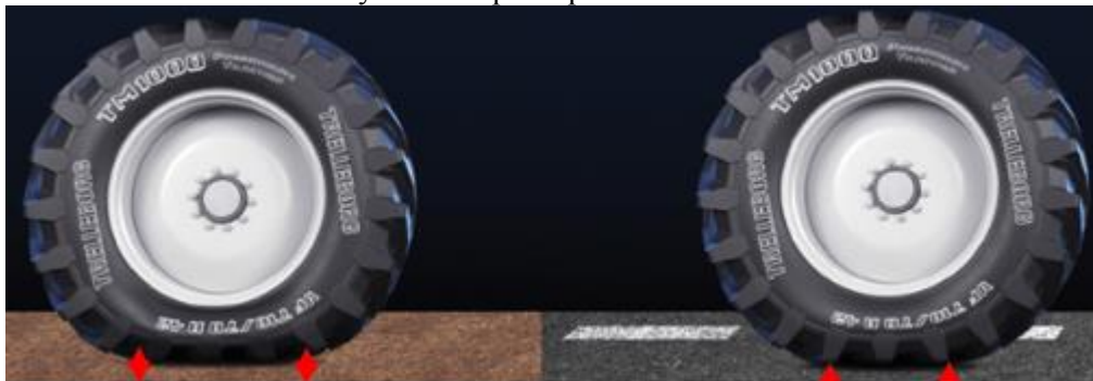
Рисунок 3 – Тиск в шині Standard Ag та IF Ag
