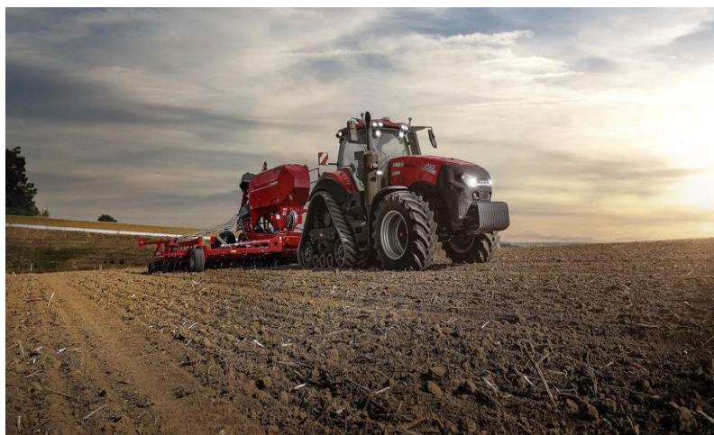
Рисунок 7 – Трактор на півгусеничному ході системи Rowtrac
