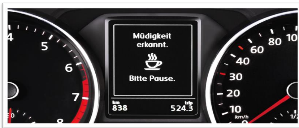
Рисунок 2 - Система розпізнавання втоми на автомобілях Volkswagen
