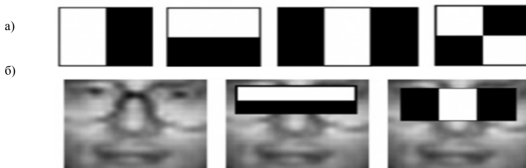
Рисунок 3-Характеристики Гаара, які використовуються для методу визначення обличчя Віоли-Джонса (а, б)
