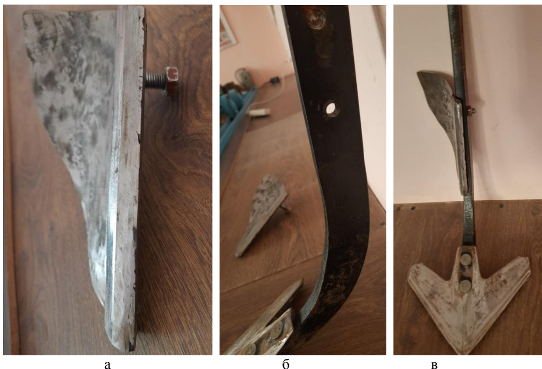
Рис. 11. Фото експериментального робочого органу: а – полиця із кріпленням; б – стійка з отвором під кріплення полиці; в – збірка
