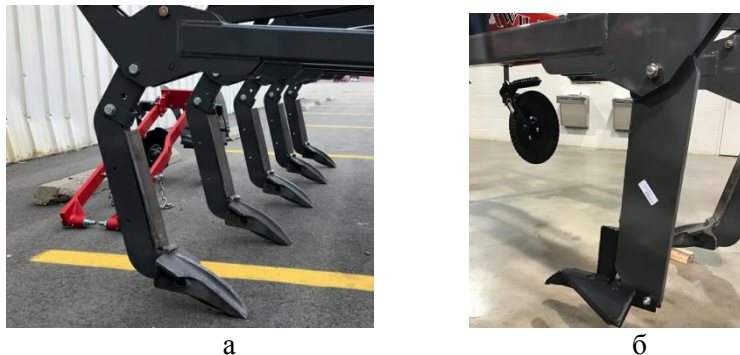
Рис. 7 - Робочі органи глибокорозпушувачів фірми Wil-Rich: а – параболічний, б – мінімальне зміщення ґрунту
