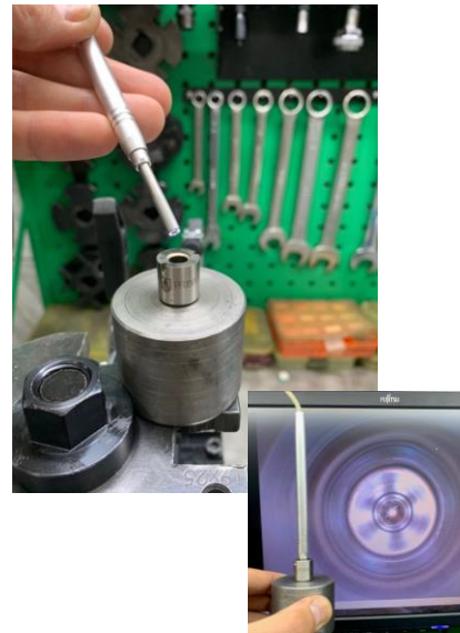
Рисунок 7 – Оцінка якості шліфування за допомогою ендоскопа «Отоскоп wifi»
