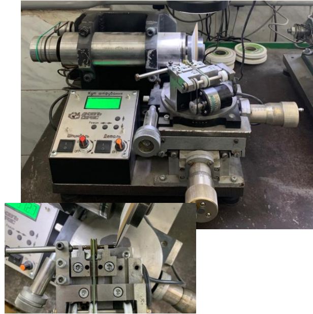
Рисунок 5 – Пристрій для перешліфування запірнього конуса голки та механізм її кріплення і обертання
