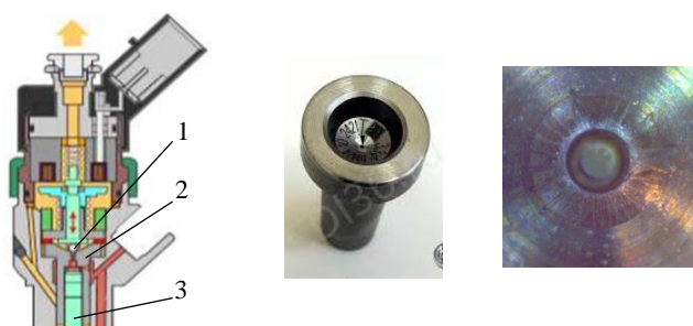
а) б) в) Рисунок 2 – Клапан керування форсунки: а – конструкція (1 – кулька; 2 – сідло; 3 – шток); б – сідло клапана; в – зношення сідла клапана
