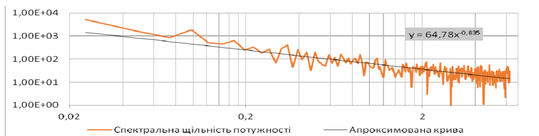
Рис. 7 – Графік спектральної щільності нерівностей дороги Київ-Харків-Довжанський (ПК 190+00,00-192+55,00) в подвійному логарифмічному масштабі
