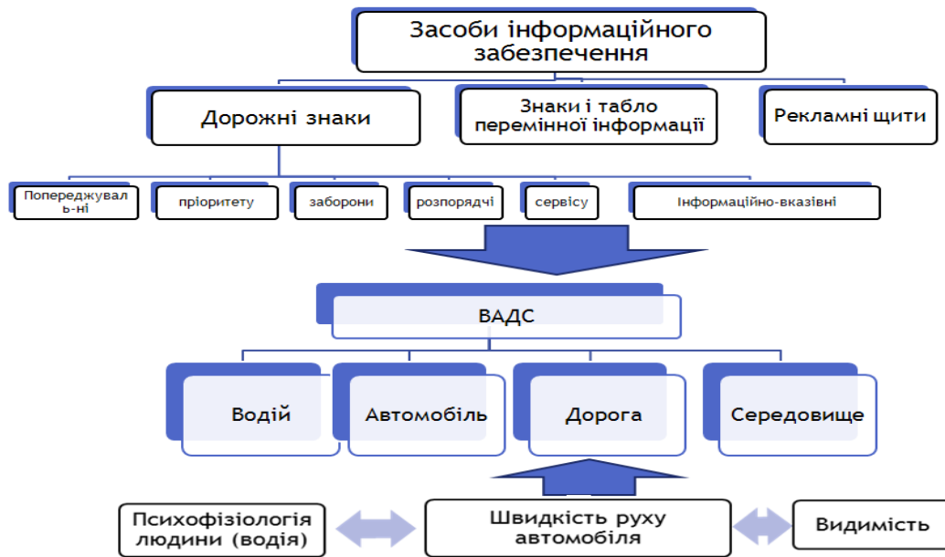
Рис.1 - Структурна схема ув'язки комплексу ВАДС з сприйняттям водієм засобів інформаційного забезпечення
