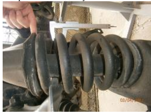
Рис. 3. Пружини підвіски Хаммера: (а) передня; (б) – задня підвіска
