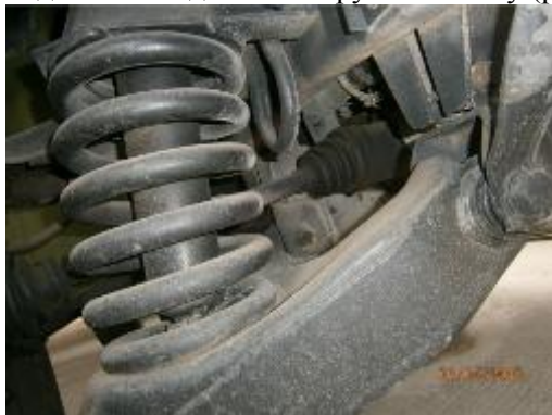
Рис. 3. Пружини підвіски Хаммера: (а) передня; (б) – задня підвіска
