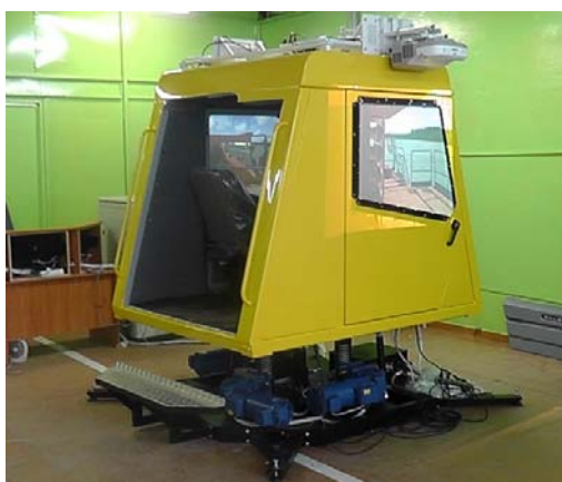
Рис. 2. Кабіна самоскида, яка встановлена на динамічній платформі
