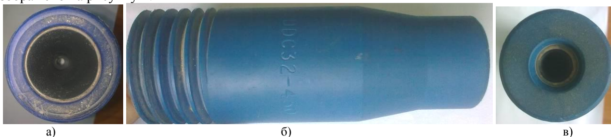
Рис. 2. Абразивоструменеве сопло UDC32–450 форми Вентурі а) вхідна широка горловина; б) вид збоку; в) вихідна вузька горловина.
