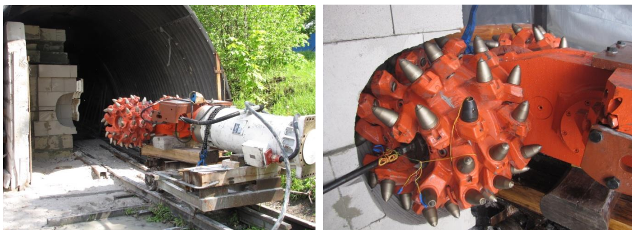
Рис.1. Проходческий комбайн с комбинированной системой пылеподавления при проведении испытаний
