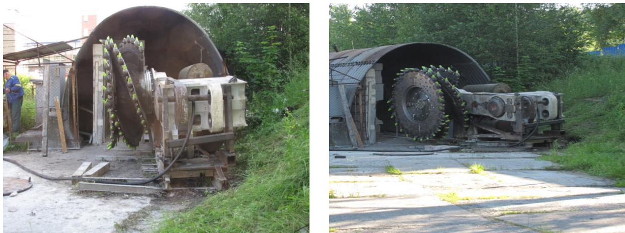
Рис.2. Очистной комбайн при подготовке к проведению испытаний
