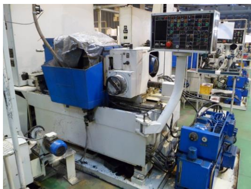
Рис. 2. Безцентрово-шліфувальний верстат SWaAKM25/1A для оброблення конічних роликів.
