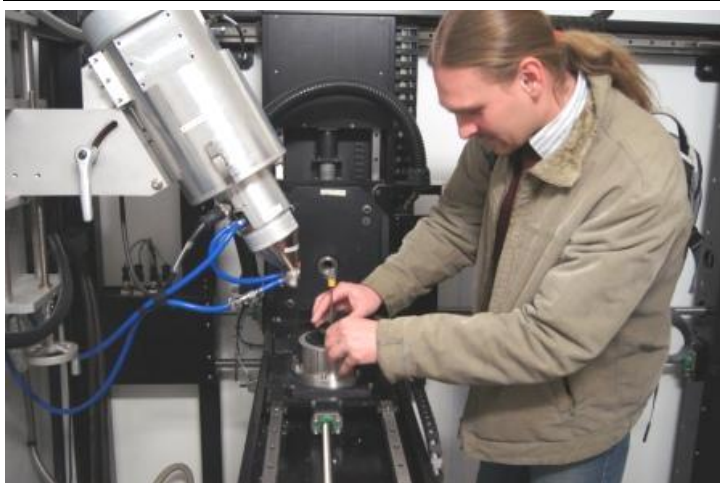
Рис. 14. Проведення експерименту на електронно-скануючому мікроскопі X-ТЕК 225/320 kV СТ SPECIAL
