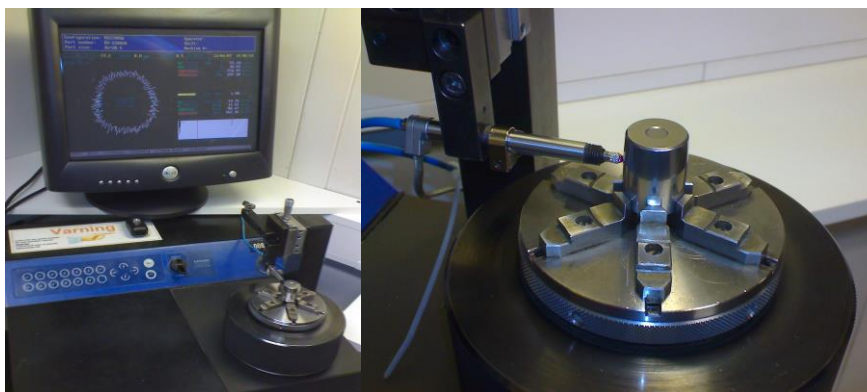
Рис. 6. Прилад MWA100C для вимірювання мікрогеометрії доріжки кочення та торця ролика
