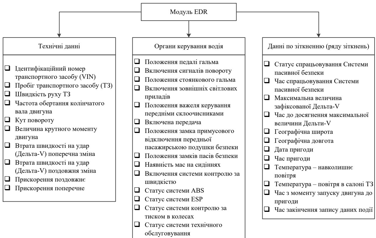
Рис. 1. Типовий масив даних, які зберігаються в модулі EDR
