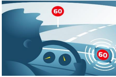
Рисунок 1. Розпізнавання напису (значень обмеження швидкості).
