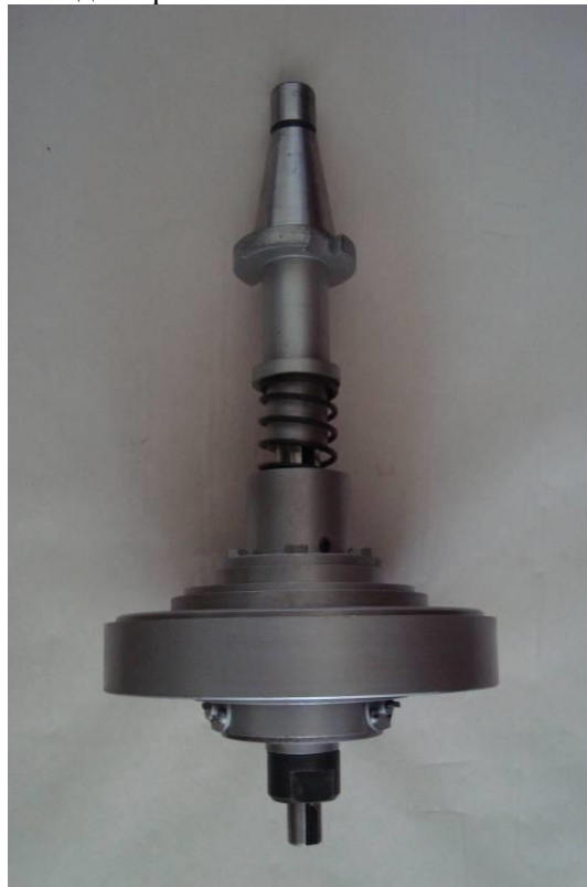
Рис. 1 Пристрій для розточування ущільнюючих циліндричних поясків під гільзи блоків циліндрів
