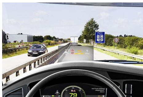
Рисунок 4. Нова розробка: проєкційний дисплей для вантажівок.
