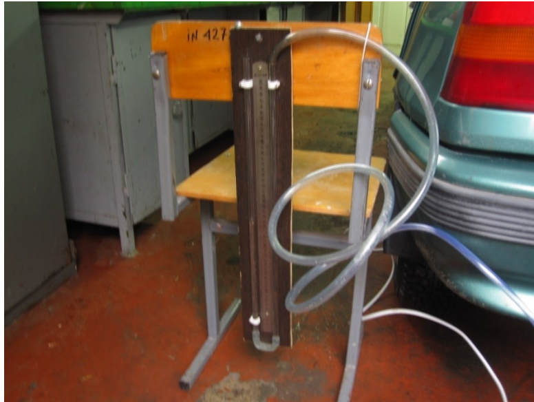
Рис. 6. Пристрій для вимірювання розрідження у системі випуску.
