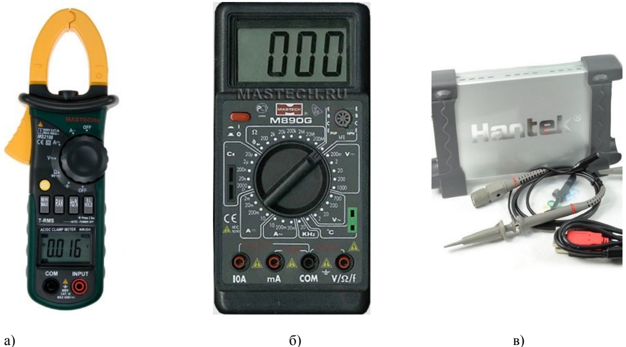
Рис. 4 Вимірювальне обладнання: а) струмові кліщі MASTECH MS2108, б) мультиметр M890G, в) цифровий USB-осцилограф Hantek 6022BE
