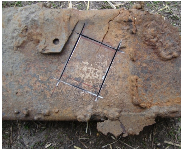
Рисунок 3 – Місце на лонжероні, звідки вирізаний зразок (у збільшеному вигляді)
