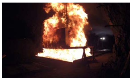
Рис. 7 - Испытание на огнестойкость открытым пламенем
