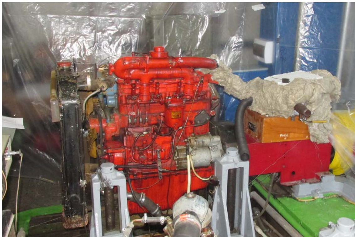
Рис. 1. Загальний вигляд гальмівної установки з дизелем Д-243
