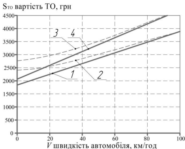
Рисунок 5 – Зміна вартості технічного обслуговування: кросовера Toyota RAV4 Hybrid AWD-i, від швидкості руху без урахування (1), (2) і з урахуванням умов експлуатації автомобіля, Toyota RAV4 2.0 AWD-i, від швидкості руху без урахування (3), і з урахуванням (4) умов експлуатації
