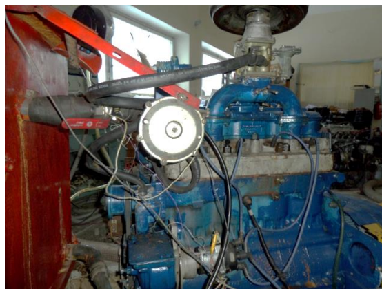
Рисунок 1 – Газовий двигун з іскровим запалюванням, переобладнаний з дизеля Д-243 для роботи на пропано-бутанових сумішах
