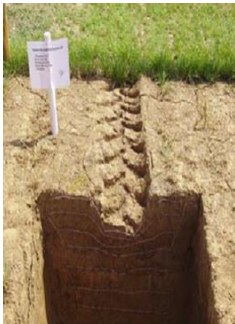
Рисунок 3 - Зміщення ліній деформації ґрунту навколо колії від колеса [18]
