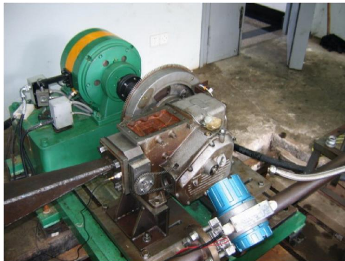
Рисунок 3. Прототип двигуна зі стисненим повітрям та електромагнітною системою змінного підйому клапанів
