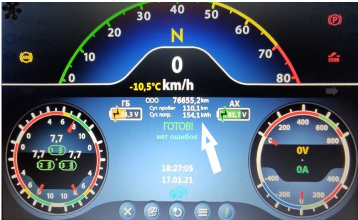
Рисунок 2 – Монітор з віртуальним лічильником витрати електроенергії за добу
