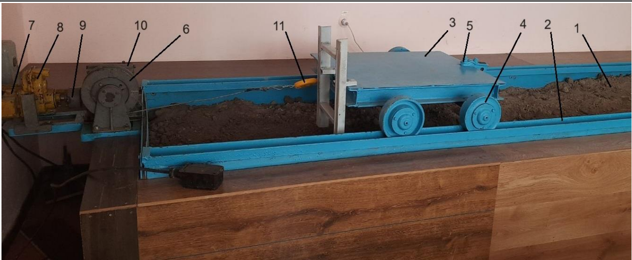
Рис. 12 - Фото ґрунтового каналу та механізму переміщення робочих органів: 1- ґрунтовий канал; 2 – направляючі; 3 – візок; 4 – колеса; 5 - механізм кріплення; 6 - лебідка; 7 – електродвигун; 8 - циліндричний редуктор; 9 - муфта; 10 - черв'ячний редуктор; 11 – динамометр
