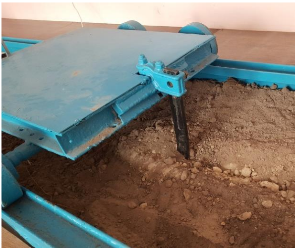
Рис. 13 - Процес експерименту з визначення тягового опору: а – штатного робочого органу; б – удосконаленого робочого органу
