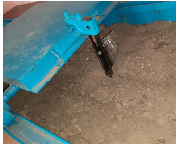
Рис. 13 - Процес експерименту з визначення тягового опору: а – штатного робочого органу; б – удосконаленого робочого органу
