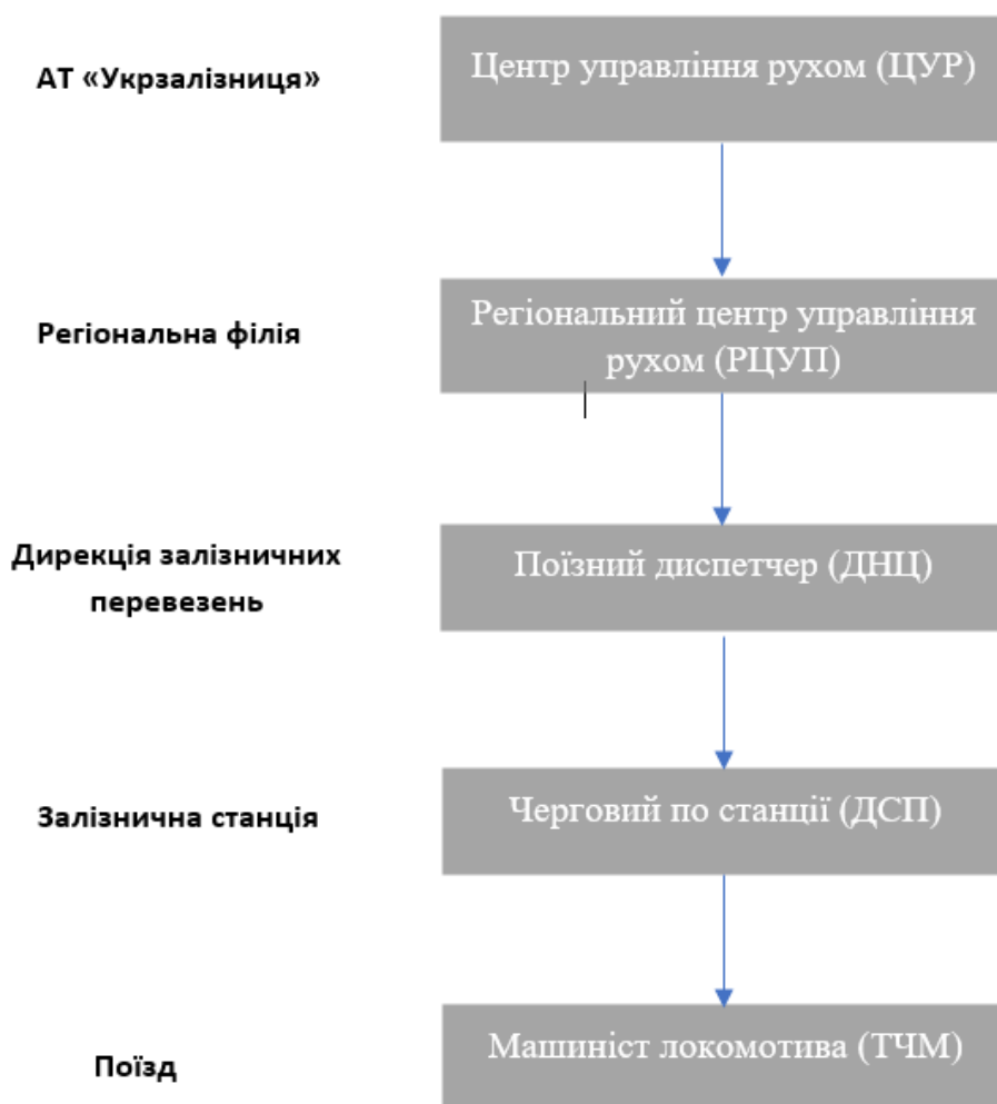
Рисунок 6 - Ієрархічна структура системи диспетчерського керування рухом поїздів
