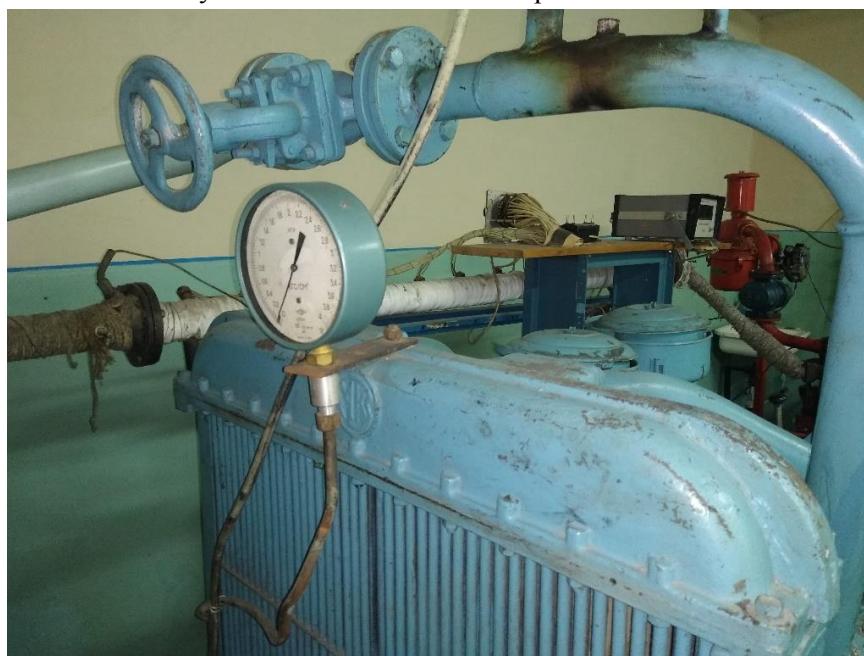
Рисунок 6 – Манометр для вимірювання тиску стисненого компресором газу
