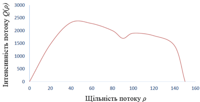
Рисунок 1 - Фундаментальна діаграма залежності інтенсивності та щільності потоку транспортних засобів
