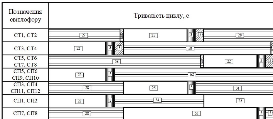
Рисунок 3 – Запропонована циклограма роботи СО на перехресті м-н Конституції – вул. Сумська – пров. Мечникова
