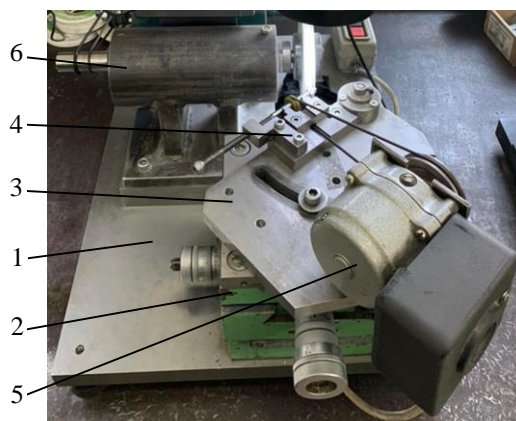
Рисунок 4 – Пристрій для перешліфування штока клапана: 1 – плита; 2 – координатний стіл; 3 – поворотний столик; 4 – система фіксації цанги із штоком; 5 – привод штока; 6 – фортуна із шліфувальним кругом
