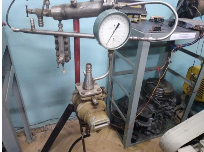
Рисунок 6 – Витратомір для вимірювання об'ємної витрати відпрацьованих газів та манометр для визначення тиску газу
