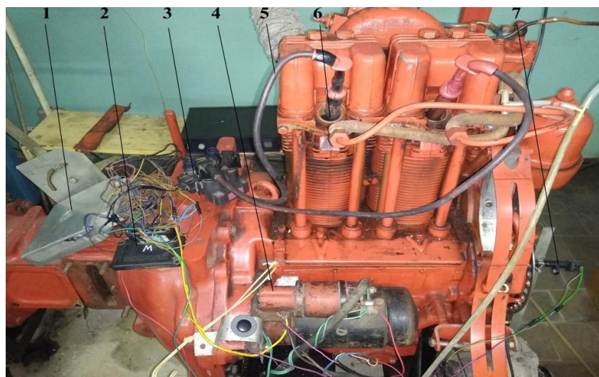
1 – електронний блок управління; 2 – комутатор системи запалення; 3 – модуль запалення; 4 – електродвигун; 5 – високовольтні дроти; 6 – свічки запалення; 7 – датчик положення колінвала Рисунок 5 – Переобладнана з дизельного палива на газове паливо система живлення двигуна Д21А1
