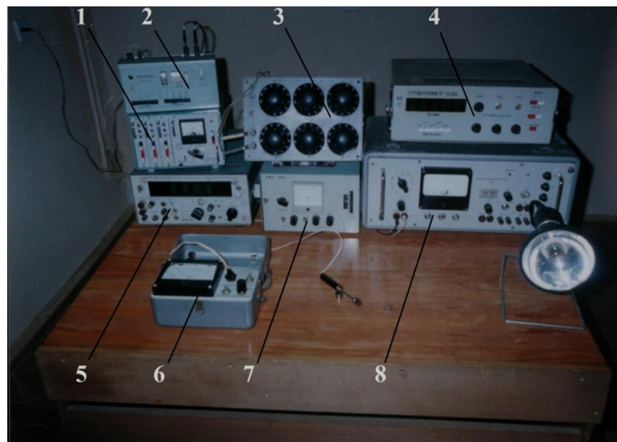
1 – підсилювач ПТ-4-01М; 2 – універсальний вимірювач RCL-3; 3 – магазин змінних опорів МССР-60М; 4 – електронний строботометр ТСт-100; 5 – цифровий вольтметр В7-20; 6 – амперметр ЕТП-М; 7 – логометр УП-2А; 8 – універсальний блок живлення УП-2
