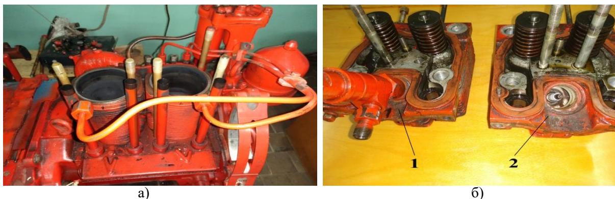
а) б) 1 – головка блока до переобладнання з встановленою дизельною форсункою; 2 – головка блока після переобладнання з демонтованою дизельною форсункою та встановленою свічкою запалення;
