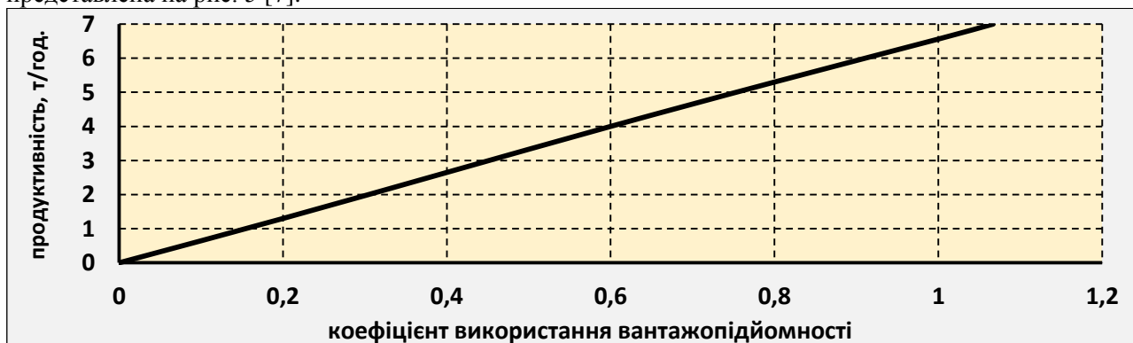
Рисунок 5 – Залежність продуктивності автомобіля від коефіцієнта використання вантажопідйомності
