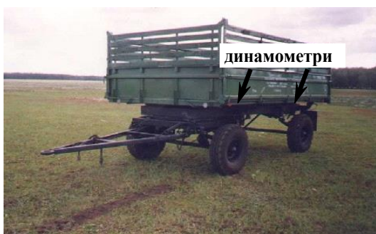
Рисунок 1. Загальний вигляд і принципова схема універсальної вимірюваної системи для дослідження навантаженості мобільних машин [12, 13]
