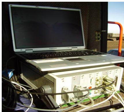
Рисунок 1. Загальний вигляд і принципова схема універсальної вимірюваної системи для дослідження навантаженості мобільних машин [12, 13]
