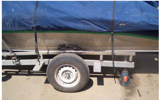
Рисунок 1.2 - Руйнування просторової рами одновісного причепа
