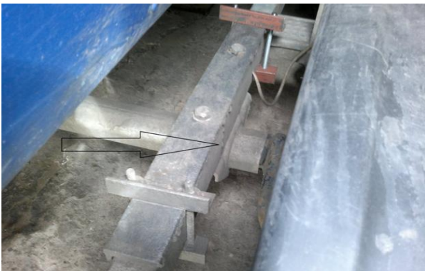
Рисунок 1.5 - Посилення лонжерона рами одновісного причепа
