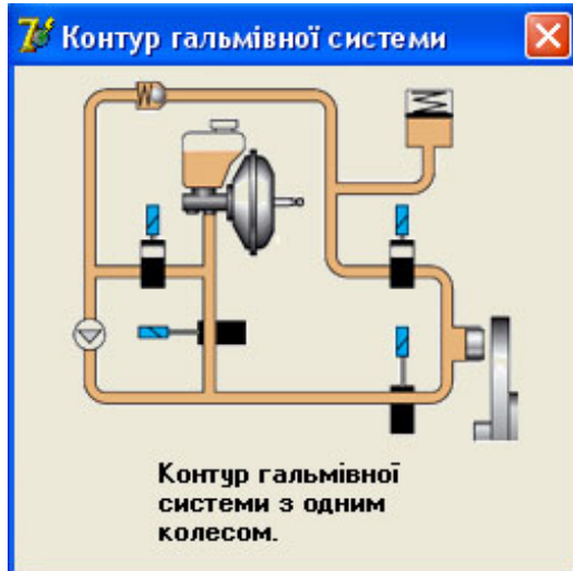
Рисунок 7. Зображення контуру гальмівної системи.
