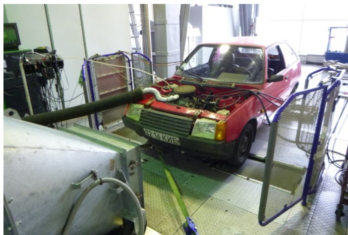
Рисунок 6 – Автомобіль ЗАЗ-1102 на випробувальному стенді
