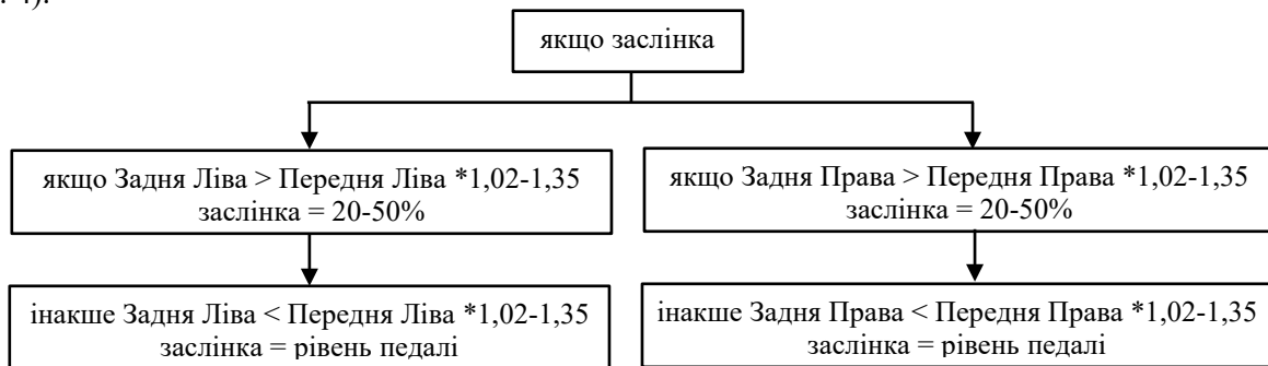
Рисунок 4. Схема функціонування TCS.
