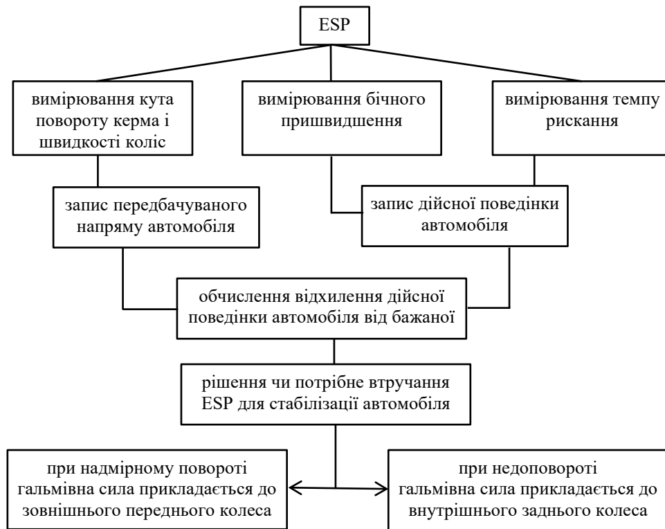
Рисунок 1. Схема функціонування ESP.
