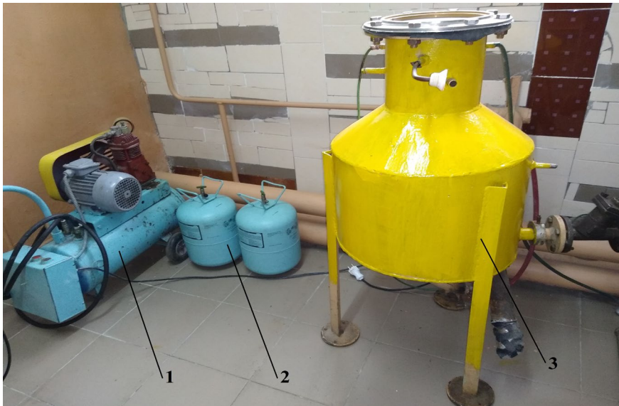
1 – компресор для закачування піролізного газу в балони з реактору; 2 – балони з піролізним газом; 3 – піролізний реактор
