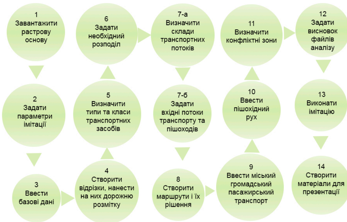
Рисунок 9 – Алгоритм створення моделі перехрестя у програмному середовищі PTV VISSIM
