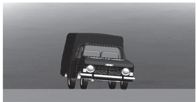
а) Крен автомобіля із штатною підвіскою (комп'ютерні випробування)
