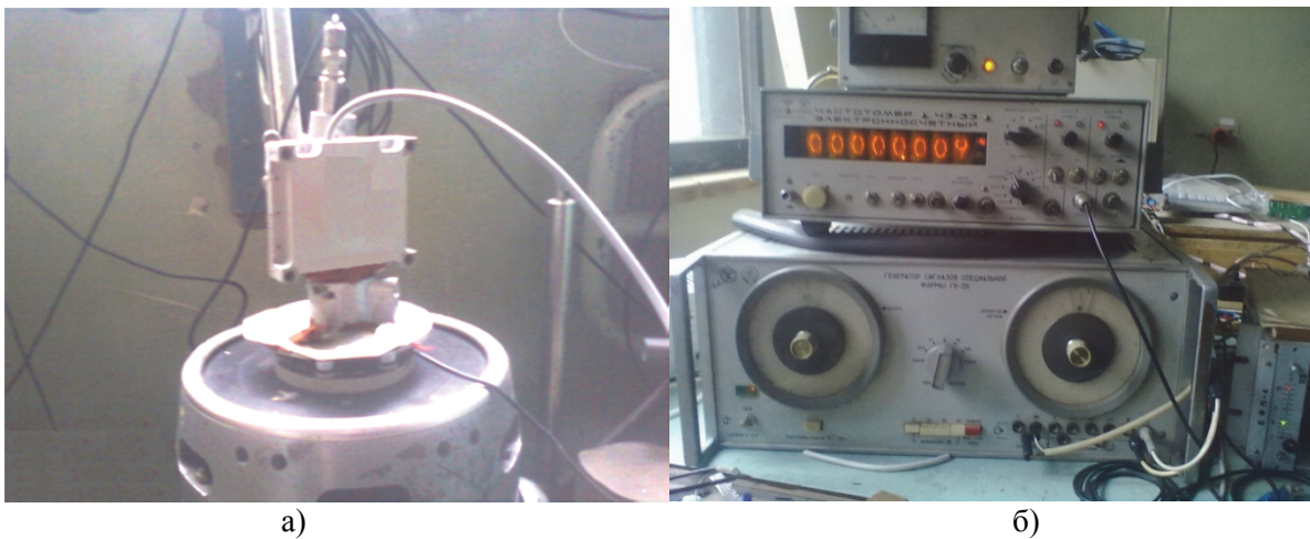
Рис. 1. Снятие показаний с датчиков ускорений MMA7260QT на вибростенде а – внешний вид вибростенда; б – вспомогательная аппаратура
