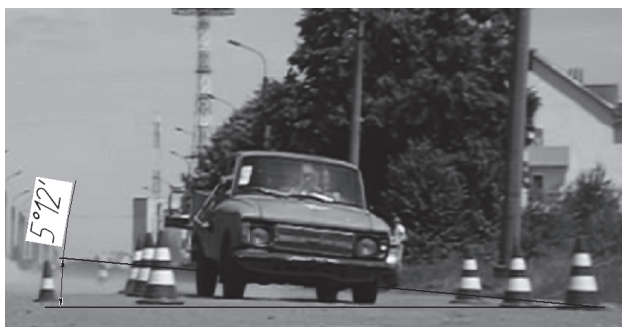
а) Крен автомобіля із штатною підвіскою (дорожні випробування)
