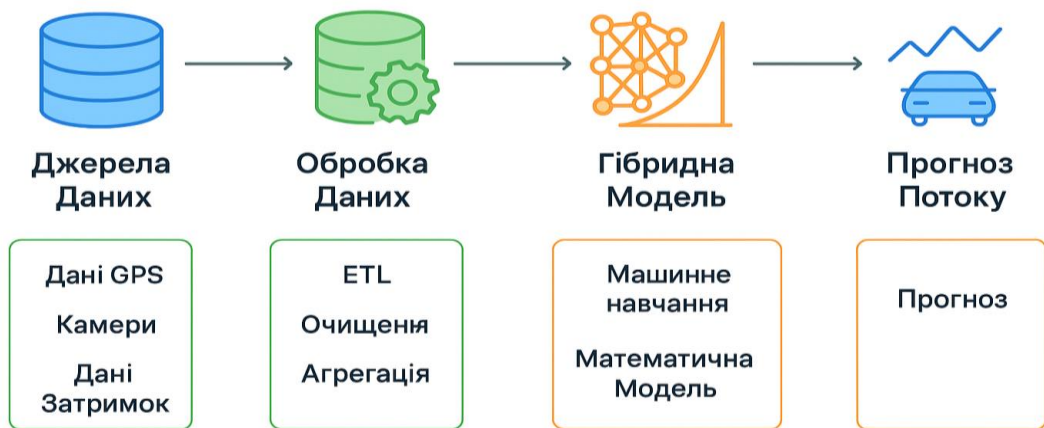
Рисунок 5 – Схема прогнозування автотранспортних потоків із використанням гібридних моделей
