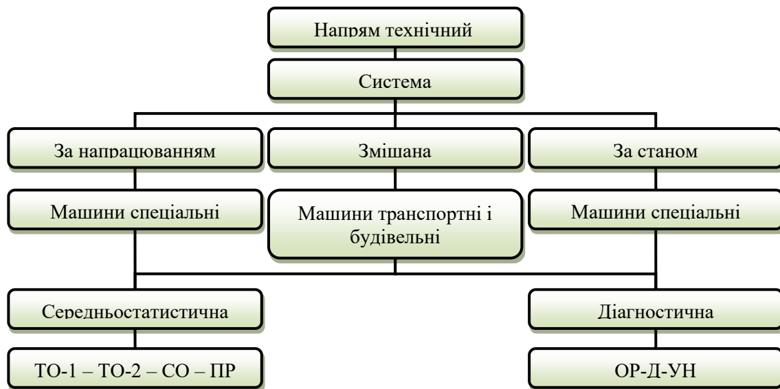
Рисунок 1 – Схема організації ТО і Р транспортних машин
