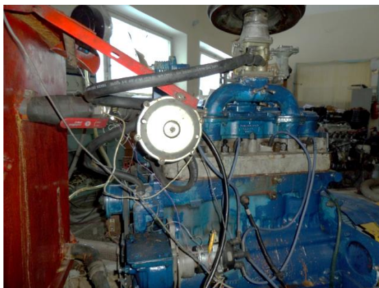
Рисунок 1 – Газовий двигун з іскровим запалюванням, переобладнаний з дизеля Д-243 для роботи на пропано-бутанових сумішах
