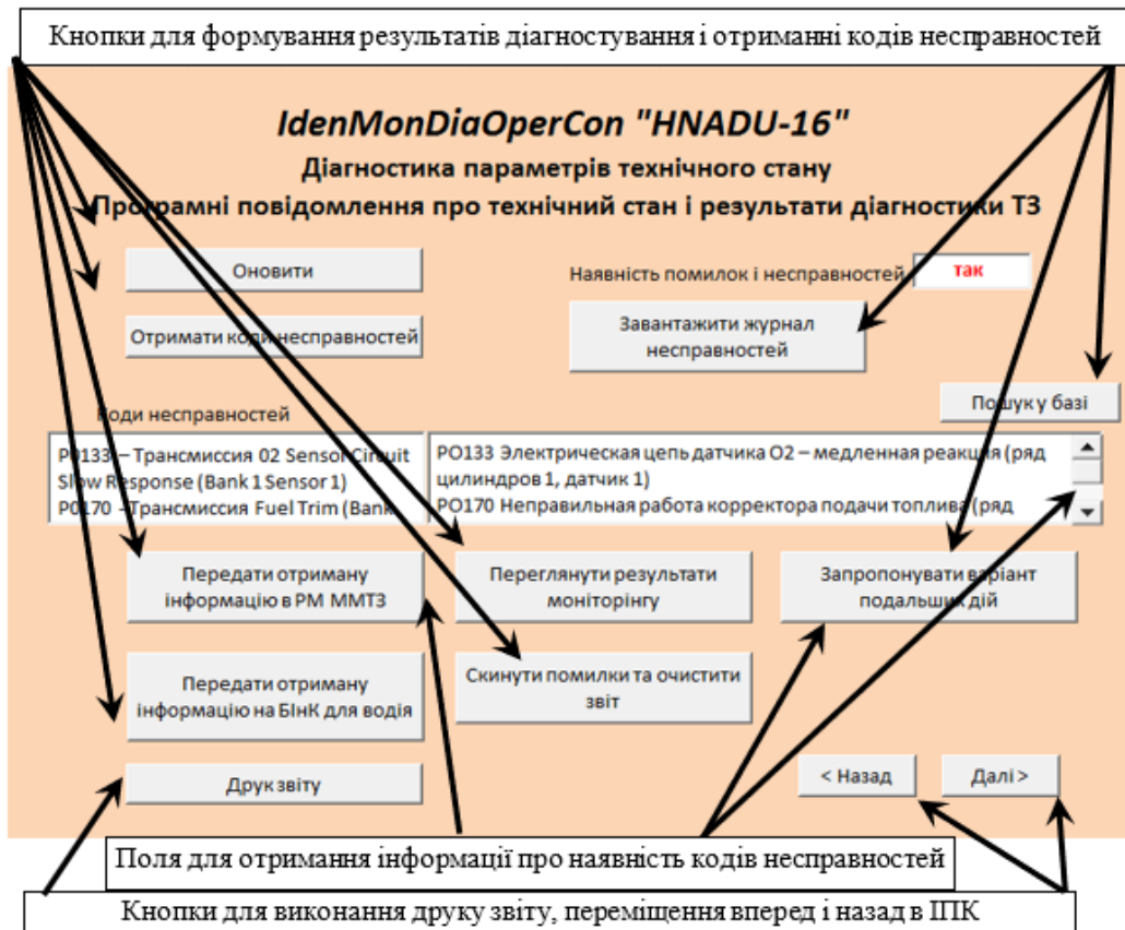
Рисунок 7 – Робоче вікно діагностування ТЗ в ПК
