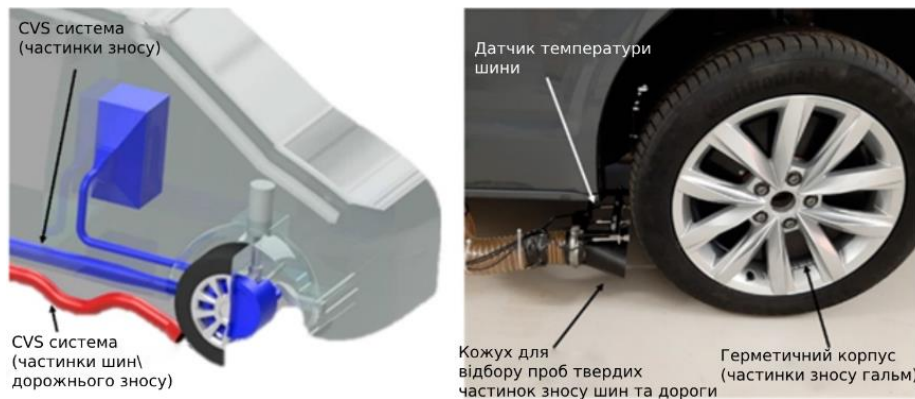
Рисунок 1 – Система щодо візуалізації потоку відбору проб для захоплення частинок зносу шини під час випробувань на дорозі: а) структура системи на автомобілі б) фрагмент системи за правим переднім колесом
