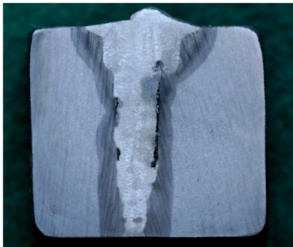
Рисунок 5 – Макрошліф багатопрохідного зварного з'єднання одержаного лазерним зварюванням у вузьку розробку.
