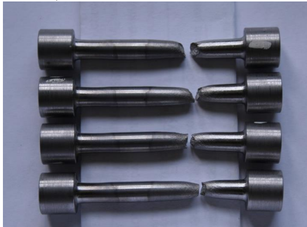
Рисунок 15 – Зовнішній вигляд зразків зварних з'єднань із сталі 25X2НМФА після випробувань на статичний розтяг.
