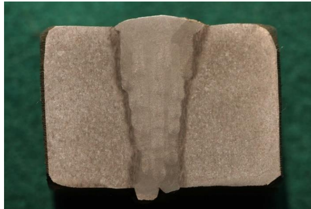
Рисунок 7 – Макроструктура зразку якісного багатопрхідного лазерного зварювання стикового з'єднання сталі 25X2НМФА ( \delta=30 мм) з підігрівом.
