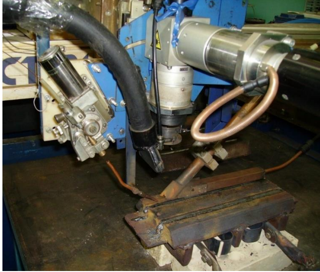
Рисунок 2 – Стиконе з'єднання сталі 25Х2НМФА ( \delta=30 мм) у зборі, зварене лазерним способом з присаджувальним дротом із підігрівом.
