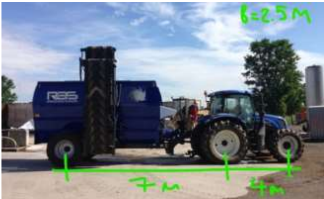
Рис. 7. Геометричні розміри між осями рухомих механізмів, що будуть рухатись по збірному залізобетонному перекритті
