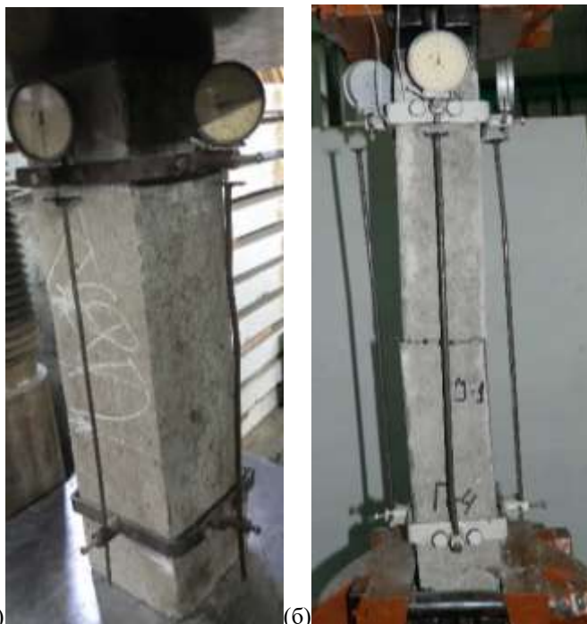
Рис. 3. Випробування зразків із фібробетону на стиск (а) та на розтяг (б)
