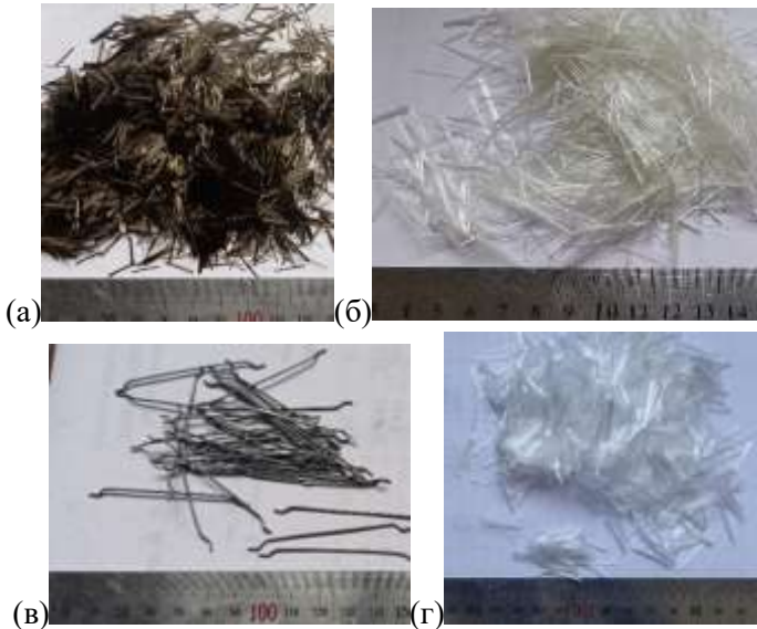
Рис. 1. Фіброве армування бетону: (а) базальтова, (б) скляна, (в) сталева та (г) поліпропіленова фібри
