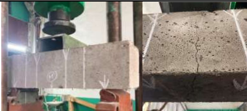
Рис. 2. Випробування призм із фібробетону на розтяг при згині
